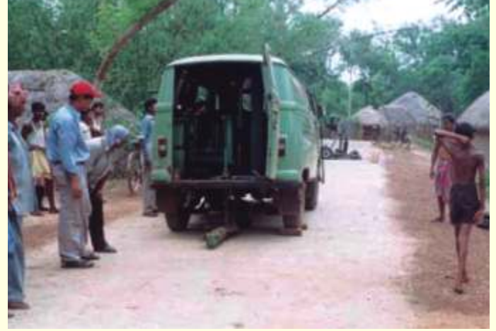
चित्र-6 एफ. डब्लू. डी. द्वारा पेवमेन्ट का मूल्यांकन
